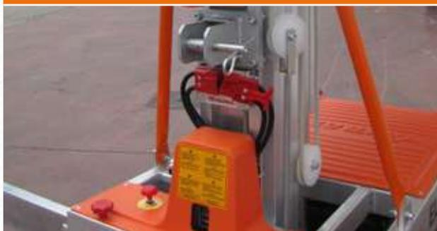
**AT 10.1:** Alimentazione batterie 12 v con attacco elettrico al trattore.
