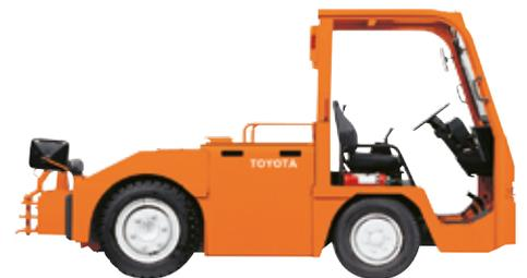
*I modelli compatti 4CBT sono dotati di un telaio stretto da 800 mm e sono disponibili con portate di 2, 3 e 4 t*
