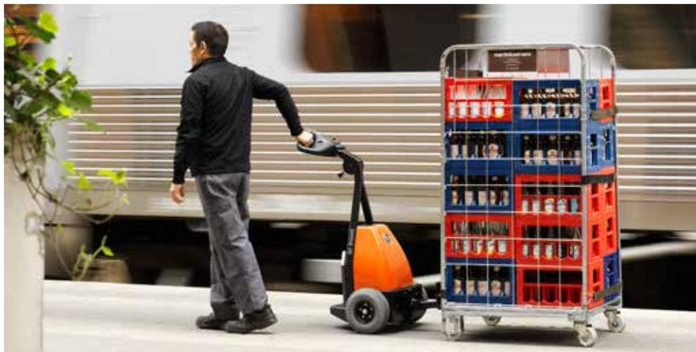
Queste unità con guida a piedi possono essere utilizzate all'interno di un processo di movimentazione integrato per provvedere agli spostamenti dei carichi più pesanti.
