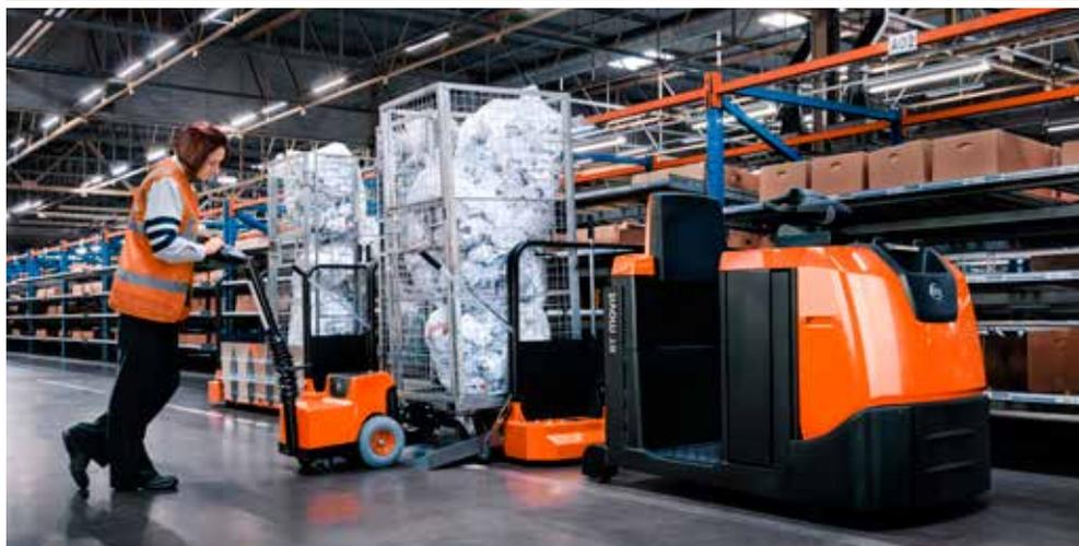
Il modello BT Movit TWE080N è una versione compatta ed economica che offre una minore lunghezza ed un sistema di trazione a differenziale che permette un raggio di curvatura più stretto. Grazie al suo peso ridotto, questo modello è estremamente facile da manovrare.
