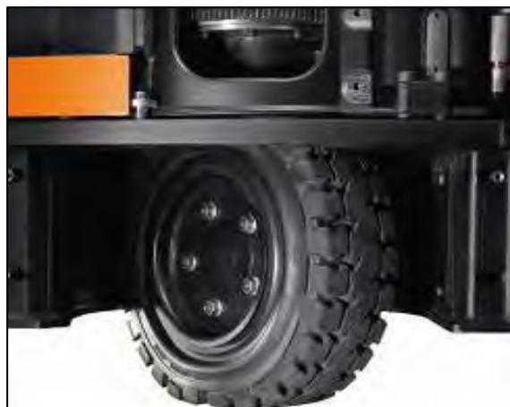
Questo tipo di gommatura e la costruzione del carrello offrono notevoli benefici in ambito applicativo, infatti garantendo una luce netta sotto al carrello, dimensione  $m_2$  da scheda tecnica, di 145mm è possibile operare anche su superfici irregolari e sconnesse, quali asfalto, cemento industriale, rampe e superfici bagnate.
