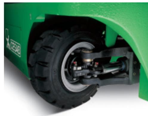
L'assale posteriore di nuova concezione è montato su silent blocks per migliorare l'ergonomia di guida e ridurre le vibrazioni durante la marcia.
