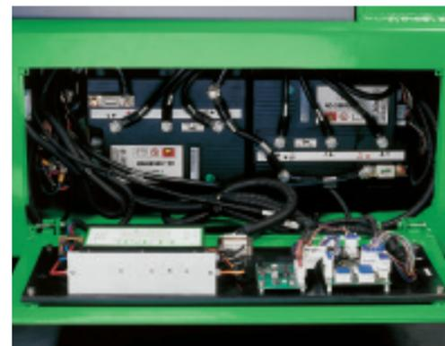
Eccellente accesso al controllo elettronico, collocato nel vano telaio protetto all'interno, con comoda apertura a vassoio. Tutte le funzioni sono programmabili. La diagnostica è semplice ed immediata.
